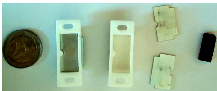
FIGURE 1: Aimant de placard. On démonte facilement le dispositif commercial à l'aide d'un tournevis pour en extraire l'aimant en ferrite noir visible à droite.
