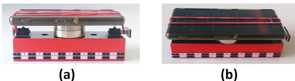
**Abbildung 5.2:** Aufbau des Wagens für das Smartphone-Experiment auf der Luftkissenbahn aus zwei Perspektiven, (a) Bild von vorne, (b) Bild von schräg oben. Durch eine glatte Erhöhung wird das Smartphone vor Kratzern durch den Wagen geschützt. Die Befestigung des Smartphones erfolgt durch ein Gummiband, welches an den Fadenhaltern des Wagens befestigt wird.
