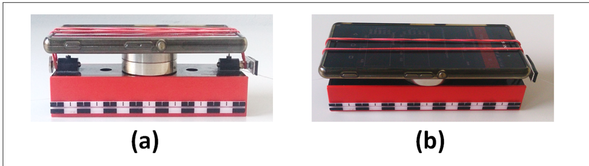
Abbildung 3: Beispielhafter Aufbau des Gleiters für die Luftkissenbahn
