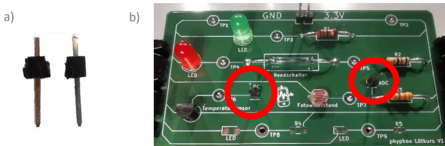
Abb. 15: Die getrennten Stiftleisten, in a) abgebildet, an die in b) markierten Stellen einlöten.
