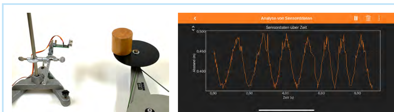
Abb. 7. Aufbau periodische Rotationsbewegung sowie Messergebnisse. Alternativ kann auch ein Drehteller oder Bürostuhl verwendet werden.
